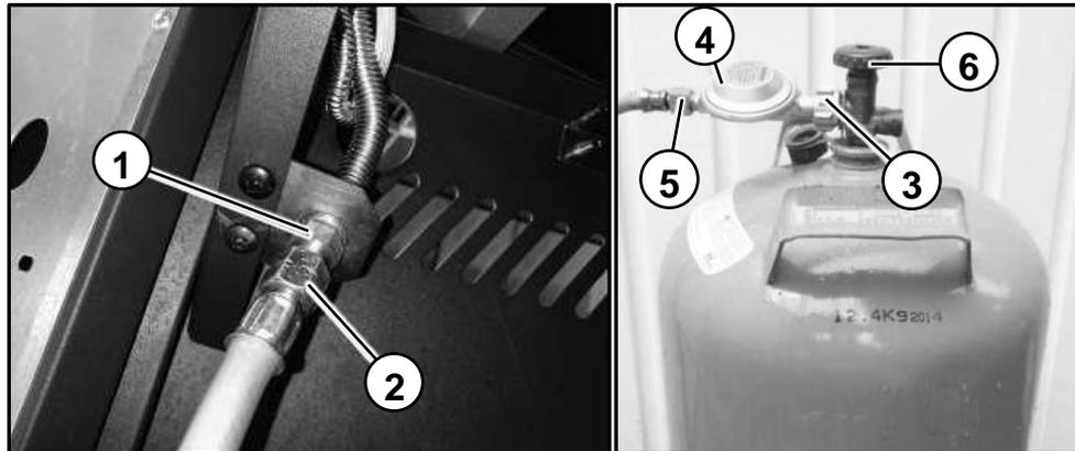
1. Entfernen Sie den Stopfen von dem Gasanschluss (1)
