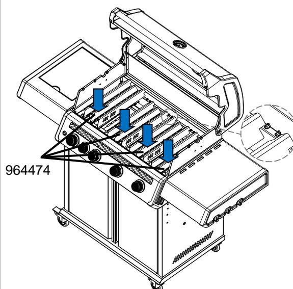
Flammenverteiler mittig über die Hauptbrenner platzieren. Luftschlitze bitte nach vorne ausrichten.
