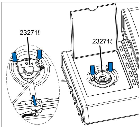
Brennereinheit vorsichtig einsetzen und mit den zuvor entfernten M4X10 Schrauben befestigen.
