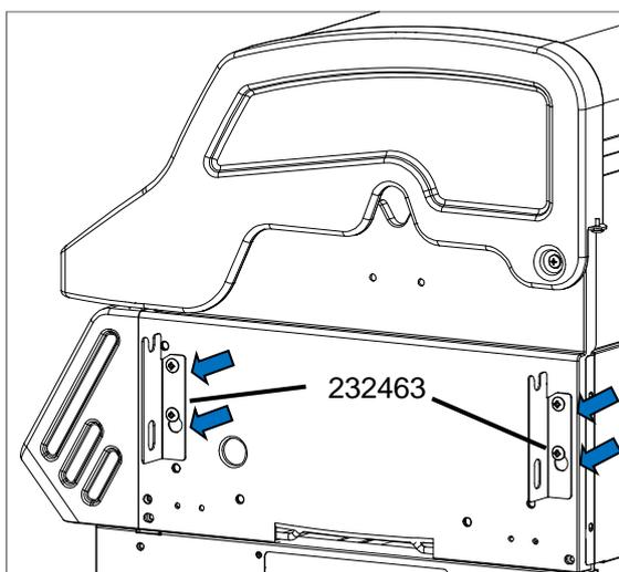
1. Die Seitenhalterungen über die untere Schraube an die Grillwand anlegen.
