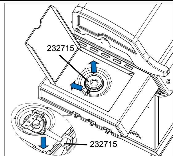
1. Entfernen Sie die M4X10 Schrauben der Brenneinheit. Dabei die Einheit mit der Hand festhalten, damit diese nicht auf den Boden fällt.
