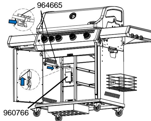
1. Batteriebox (Batteriegröße: D) an der Rückwand anbringen. Diese wird magnetisch gehalten.
