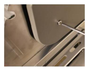
Dazu mit einem Schraubenzieher außen die Schraube fixieren und innen mit einem Schlüssel die Schrauben lösen.
