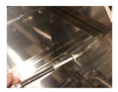
Um den Deckel von der Grillkammer zu lösen, müssen die Schrauben links und rechts gelöst werden.
