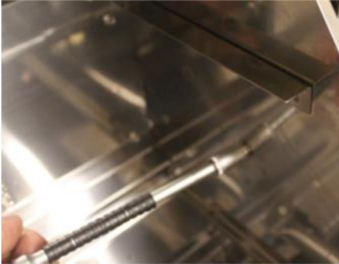
Um den Deckel von der Grillkammer zu lösen, müssen die Schrauben links und rechts abgeschraubt werden.
