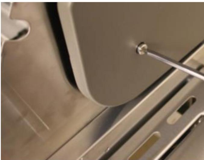
Dazu mit einem Schraubendreher außen die Schraube fixieren und innen mit einem Schlüssel die Schrauben lösen.
