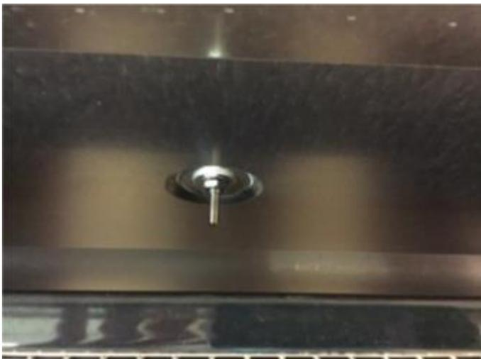
Thermometermutter lösen und das Thermometer entfernen
