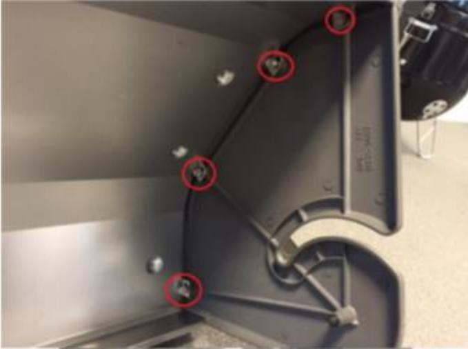
An der Innenseite die Schrauben lösen. Dann kann der Hitzeschutz entfernt und der neue in umgekehrter Reihenfolge montiert werden.
