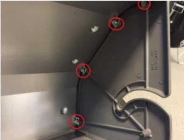
Jetzt innen den Deckel die Schrauben lösen, damit die Chromleiste danach entfernt werden kann.
