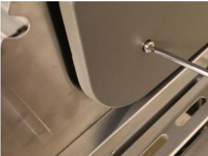
Dazu mit einem Schraubendreher außen die Schraube fixieren und innen mit einem Schlüssel die Schrauben lösen.
