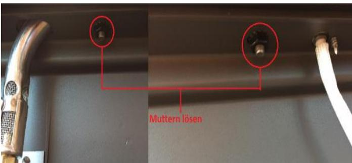
Durch hinten am Gerät zwei Mutter etwas zu lösen, kann das Gitter entfernt werden.
