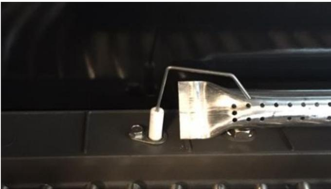
Durch die Elektrode etwas vom Brenner weg zu biegen wird die Funke größer.
