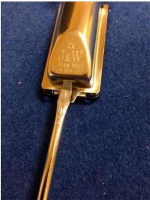
Nach dem Entfernen von dem Gehäuse können Sie die Lampe austauschen und ersetzen. In umgekehrter Reihenfolge wieder zusammen schrauben.
