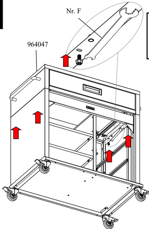
Verschrauben Sie den Deckel mit Schublade mit dem von Ihnen zusammengebauten Unterwagen mit 4 Stk. HEX-M6x12 Schrauben.
