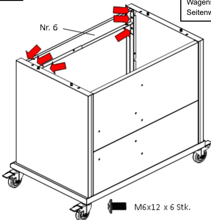
Verschrauben Sie mit 6 Stk. M6x12 Schrauben die Querstrebe vorne (6) des Wagens mit der linken und rechten Seitenwand.
