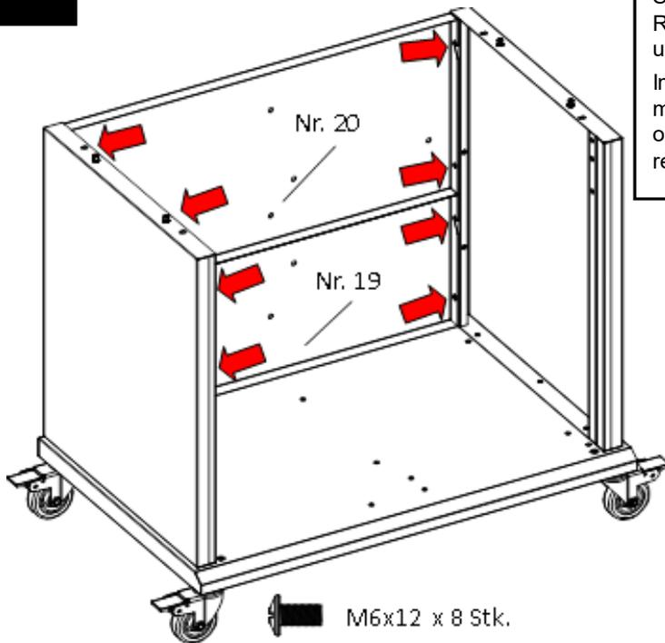
Verschrauben Sie zuerst mit 4 Stk. M6x12 Schrauben die untere Rückwand (19) mit der rechten und linken Seitenwand.
