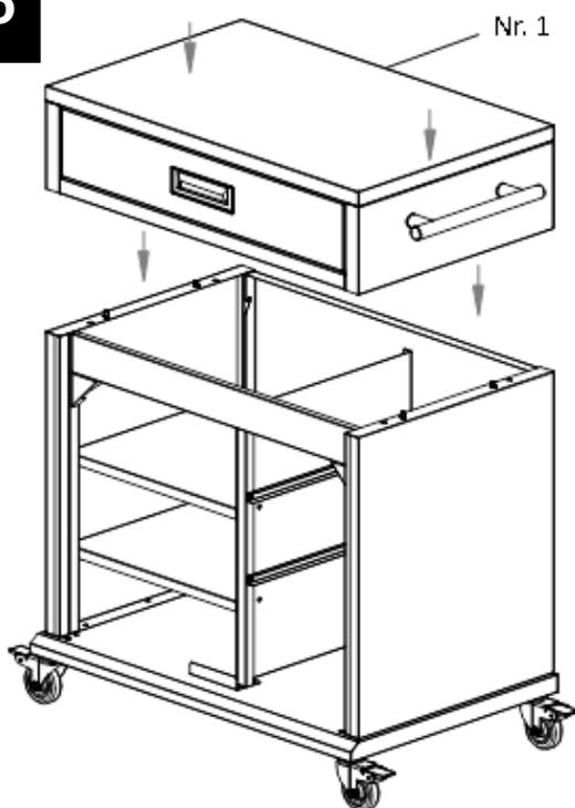
Setzen Sie nun den Deckel mit Schublade (1) auf den von Ihnen zusammengebauten Unterwagen.
