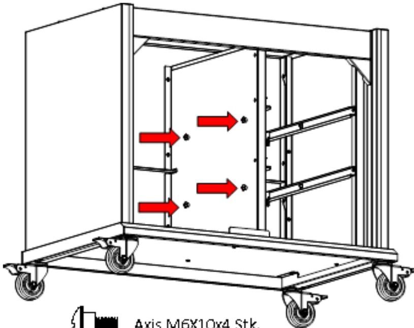
Schrauben Sie die 4 Stk. M6x10 Schrauben für die Regalböden (4) in die Trennwand (5) ein.
