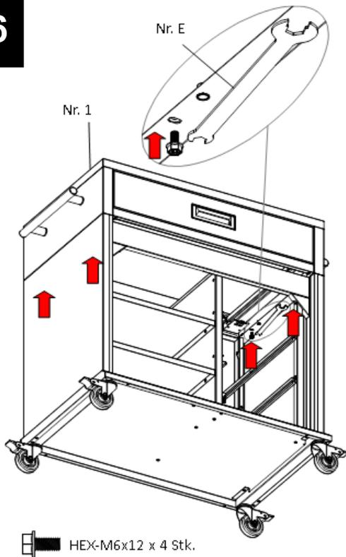
Verschrauben Sie den Deckel mit Schublade mit dem von Ihnen zusammengebauten Unterwagen mit 4 Stk. HEX-M6x12 Schrauben.
