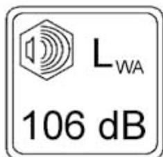
Garantierter Schallleistungspegel nach Richtlinie 2000/14/EG
