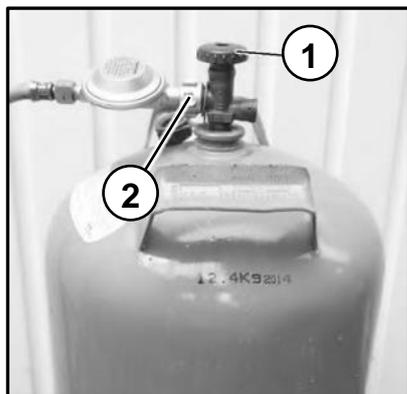
1. Drehen Sie das Ventil (1) der Flüssiggas-Flasche zu
