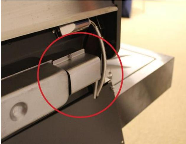
Erst muss man noch das hintere Abdeckblech befestigen indem man diese vorne mit den Schrauben befestigt.
