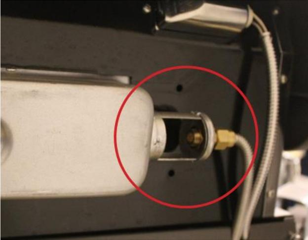
Jetzt kann der Brennerrohr von innen mit eine Rohrbürste gereinigt werden.
