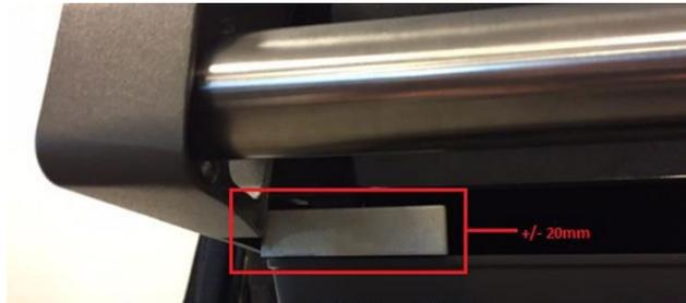
Auf der Seite wo der Scharnierpunkt wackelt können Sie vorne etwas zwischen Deckel setzen und auf der andere Seite auf dem Griff etwas Kraft nach Unten geben. So wird die Spannung im Deckel und wackelnden Effekt weggenommen.
