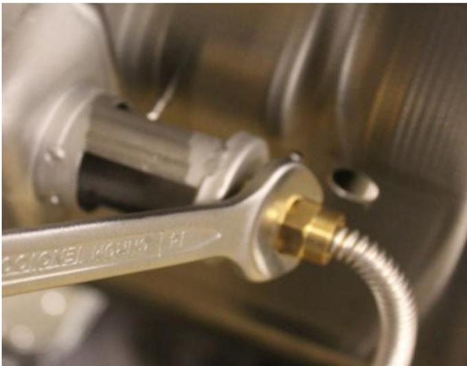
Jetzt die Gaszuleitung mit einem Schraubenschlüssel vom Heckbrenner lösen.
