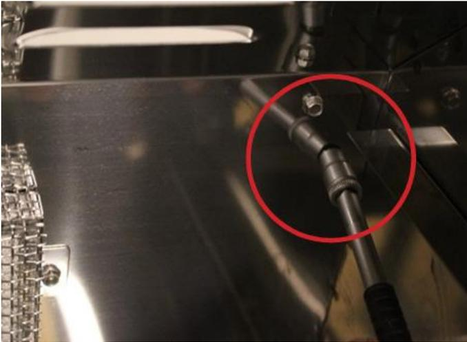
Um den Heckbrenner ausbauen zu können, muss man das hintere Abdeckblech abschrauben.
