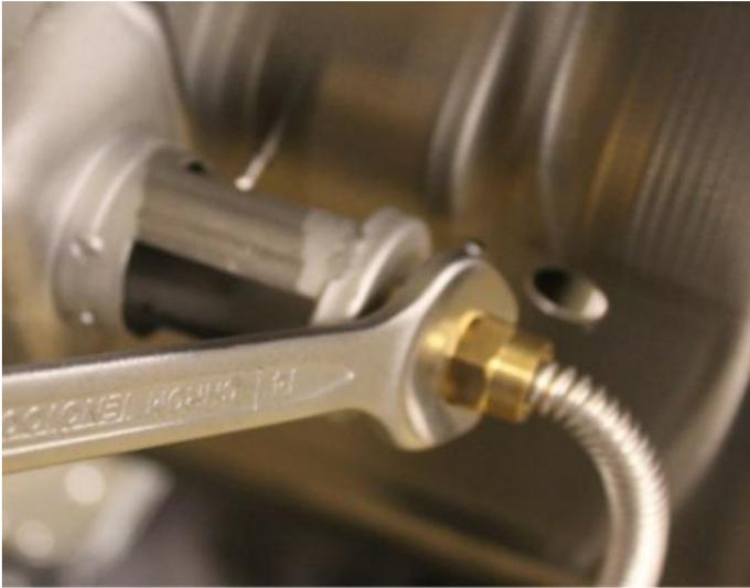
Nun die Gaszuleitung hinten mit dem Heckbrenner verbinden.
