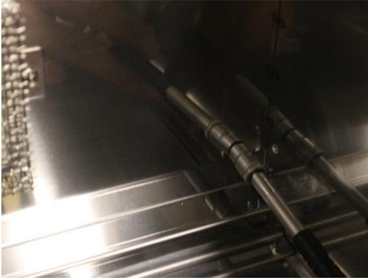
Jetzt nur noch rechts in der Grillkammer die obere kleine Abdeckung des Heckbrenners mit Schrauben oben und unten befestigen
