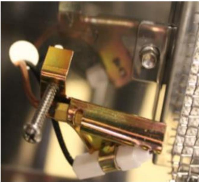
Die Zündung des Heckbrenners an ihren Platz befestigen mittels teilweise die Schraube an zu drehen.
