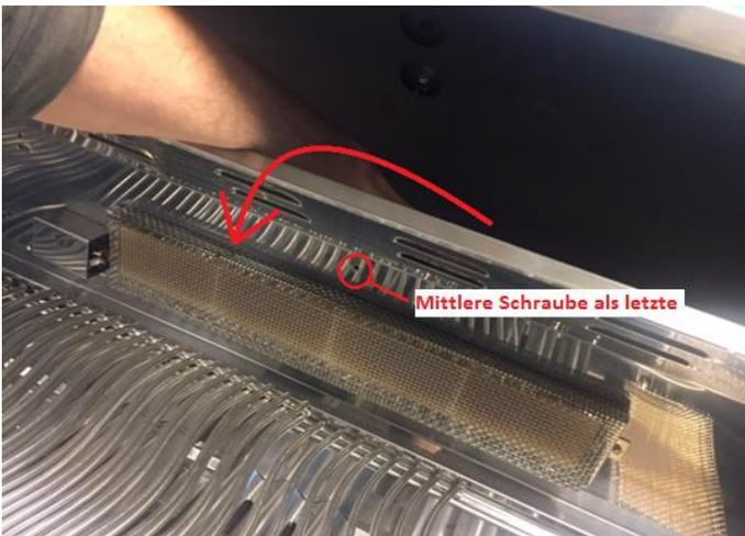
**Tipp:** Die mittlere Schraube als letzte lösen, damit der Abdeckung mit einer Hand entfernt werden kann (Bild).
