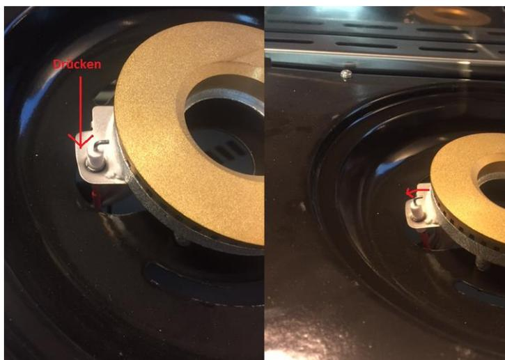
Wenn der Seitenbrenner schwer zündet kann es sein das die Funke zu klein ist. Das ist ziemlich einfach zu beheben durch die Elektrode etwas von dem Brenner weg zu biegen. Hiermit wird die Funke größer und wird das Gas besser gezündet. Beachten Sie das den Seitenbrenner empfindlich ist vom Wind. Das heißt dass das Gas erstmal durch den Brenner gehen muss und den Wind möglicherweise vermeidet dass das Gas die Elektrode erreicht. Durch langsames drehen des Knopfes läuft Gas durch den Brenner.
