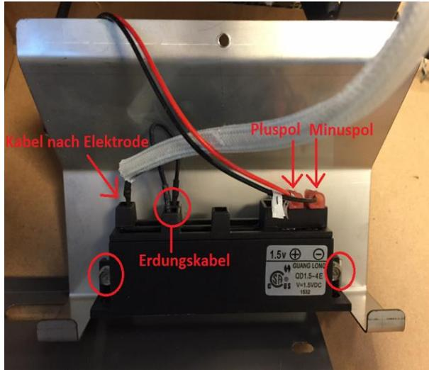
Das Kabel von der Heckbrenner Elektrode lösen.
