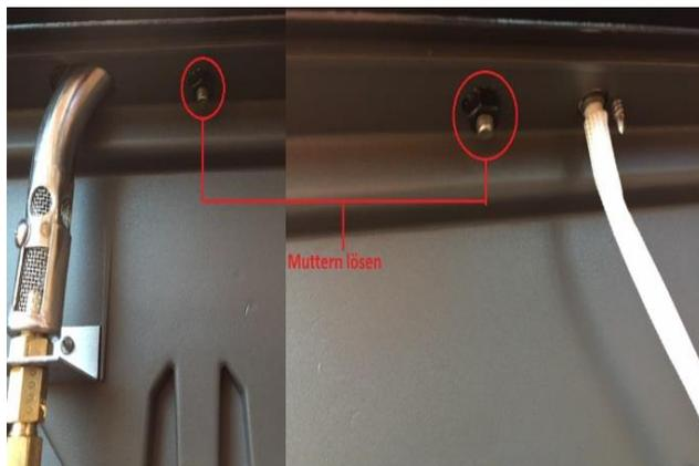
Auf die Rückseite finden Sie die Mutter. Diese ein bisschen Lösen damit das Gitter vom Heckbrenner entfernt werden kann.
