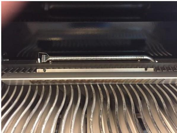
Jetzt ist die Elektrode sichtbar und nun kann die Letzte Schraube gelöst werden. Die Schraube hat einen  $\frac{1}{4}$ " Anschluss und ein Bithalter passt darauf.
