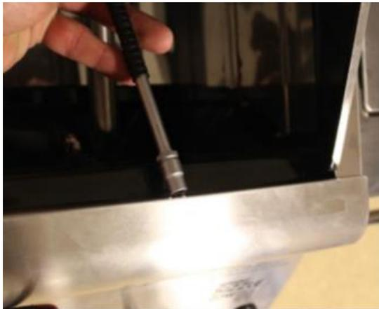
Danach das Bedienelement von der lösen, indem man die Schrauben an der Ober- und Unterkante löst.
