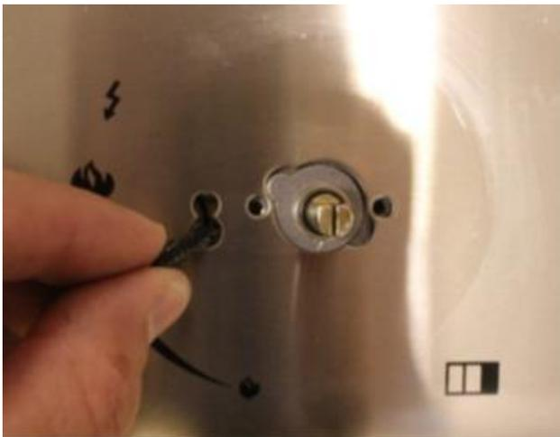
Die Led Beleuchtung durch die Löcher nach unten und nach innen drücken, um diese vom Bedienelement zu lösen.
