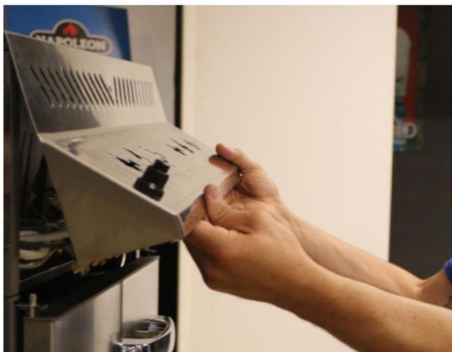
Bedienblende nach oben heben und vom Hauptgasrohr trennen.
