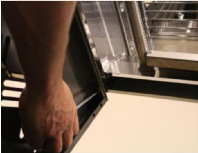
Die Firebox ein klein wenig schräg auf dem Unterbau aufliegen lassen um die unteren Schrauben vom Bedienfeld besser lösen zu können. Innen den Wagen unter dem Grillkammer befinden sich die Schrauben die gelöst werden müssen um diese etwas nach vorne schieben zu können
