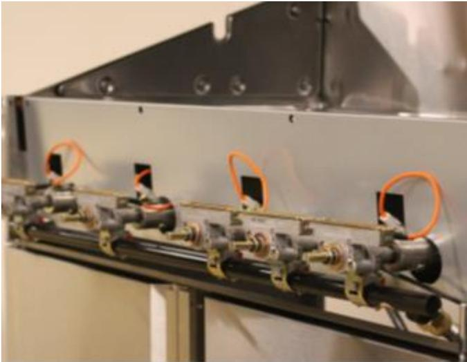
Durch lösen der Gaszuleitungen zu den Ventilen mit einem Schraubenschlüssel kann das Hauptgasrohr von den Leitungen getrennt werden. Danach muss noch der Draht wie auf dem Foto ersichtlich auch von der Zündeinheit vom Seitenbrenner getrennt werden
