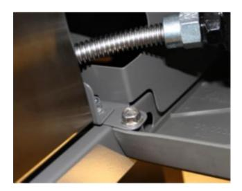
Danach das Bedienelement von der Hauptgrillkammer lösen, indem man die Schrauben an der Unterseite links und rechts löst.
