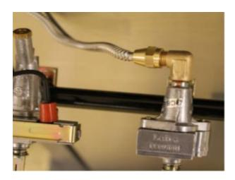
Jetzt in umgekehrter Reihenfolge die neue Gasbaugruppe montieren und alle Schraubverbindungen eines Gasleck Tests unterziehen.
