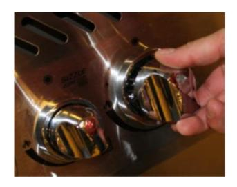
Um das Bedienelement ausbauen zu können, zuerst die Drehknöpfe abziehen.
