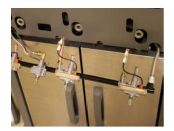
Um das Hauptgasrohr von der Grillkammer zu trennen, die Gaszuleitungen mit einem Schraubenschlüssel lösen.
