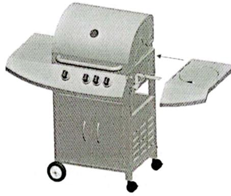
Befestigen Sie den Seitenbrenner mit 4 Schrauben.
