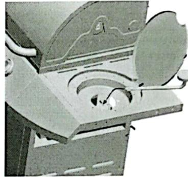
Stellen Sie sicher, dass der Gasbrenner durch das Loch geführt wird, und auf die Gasdüse am Grillwagen aufgesetzt wird.
